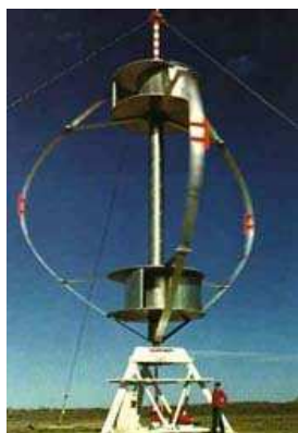
Rys. 12. Przykład konstrukcji łączonej, główny wirnik typu Darrieusa, natomiast pomocniczy Savoniusa
