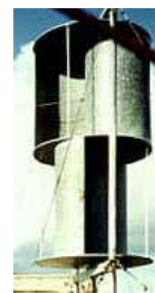
Rys. 11. Przykład konstrukcji siłowni wiatrowej o pionowej osi obrotu typu Savoniusa
