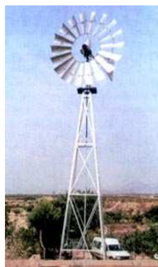
Rys. 17. Siłownia wiatrowa wielołopatowa (wolnobieżna), ze sterem aerodynamicznym
