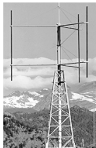
Rys. 8. Siłownia wiatrowa o pionowej osi obrotu typu H-Darrieus
