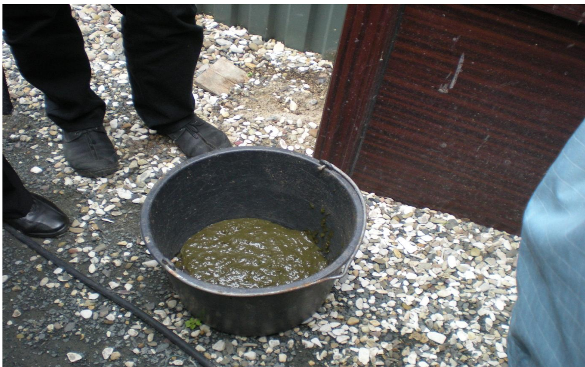
Rys. 70. Produkt fermentacji zachodzący w komorach fermentacyjnych w biogazowni
