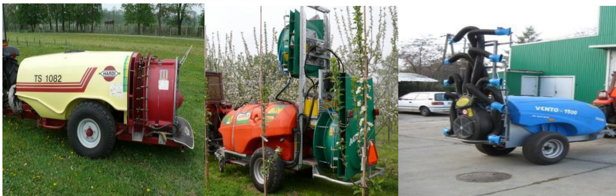
Fot. 9. Rodzaje opryskiwaczy od lewej: konwencjonalny, deflektorowy, z ukierunkowanym strumieniem powietrza
