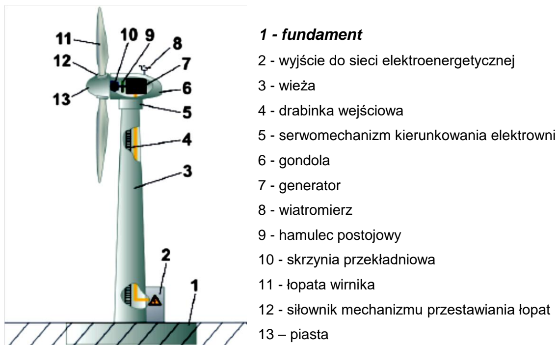
Rysunek 23. Budowa elektrowni wiatrowej. [Źródło: red. U. Gołębiowskiej, OZE odnawialne źródła energii., Koszalin, 2013]
