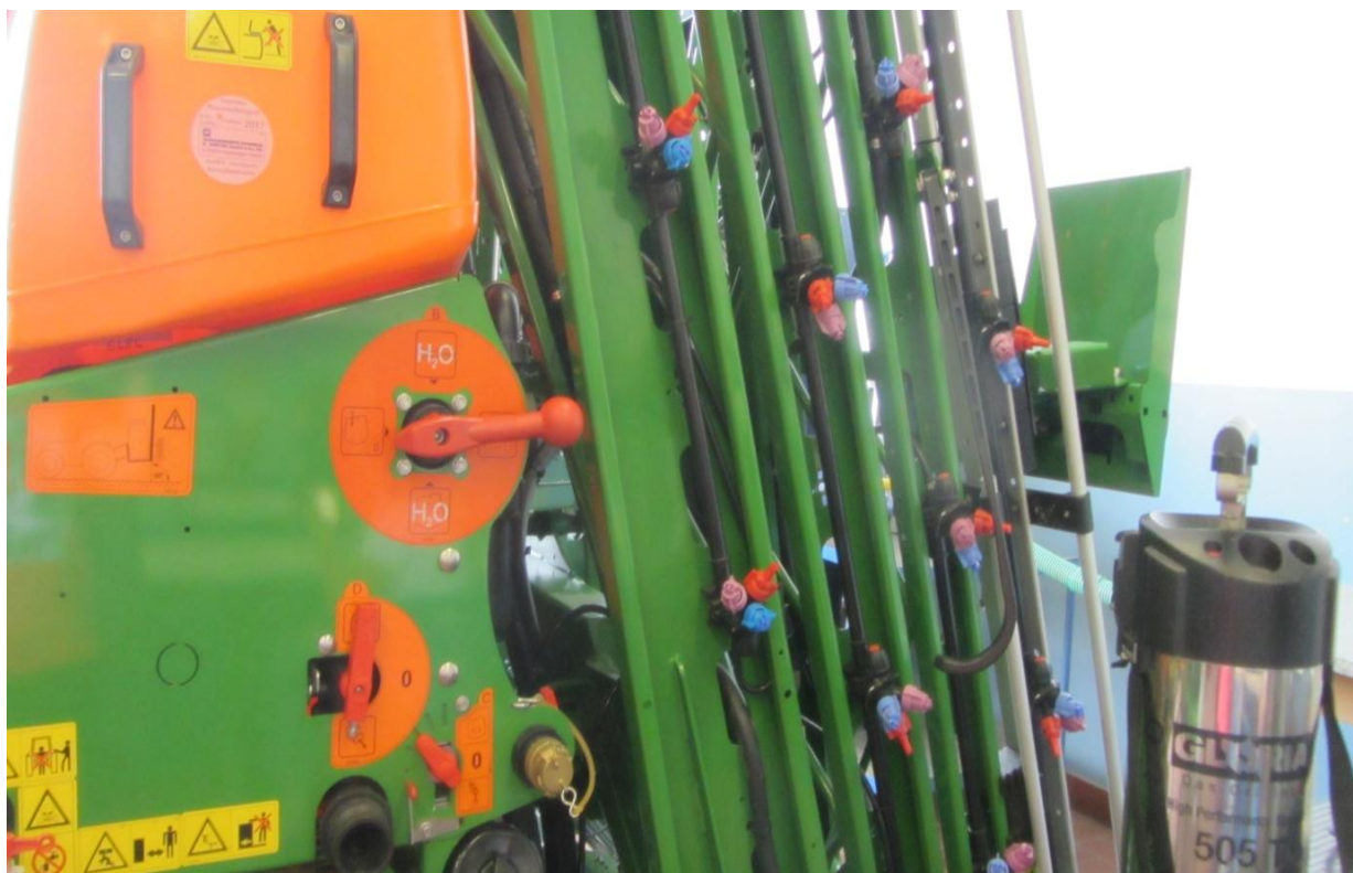
Prezentacja opryskiwacza. Fragment belki polowej z rozpylaczami.
